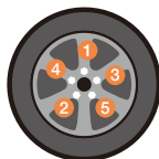
仮止めの順番 (5穴)
