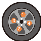
仮止めの順番 (4穴)
